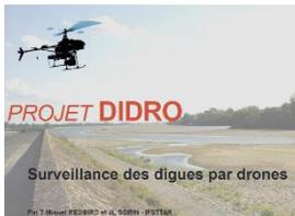
France Dignes est commanditaire du projet DIDRO qui rassemble PME, laboratoires et institutionnels. Il vise à mettre au point des solutions complètes de surveillance des digues par drone -ou autre vecteur- dans des situations diverses : crue, post-crue, routine...
