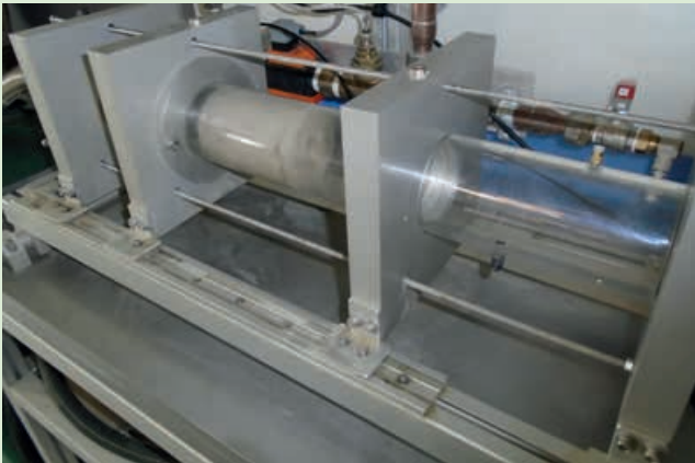
Banc d'essai dédié à l'essai d'érosion HET.
