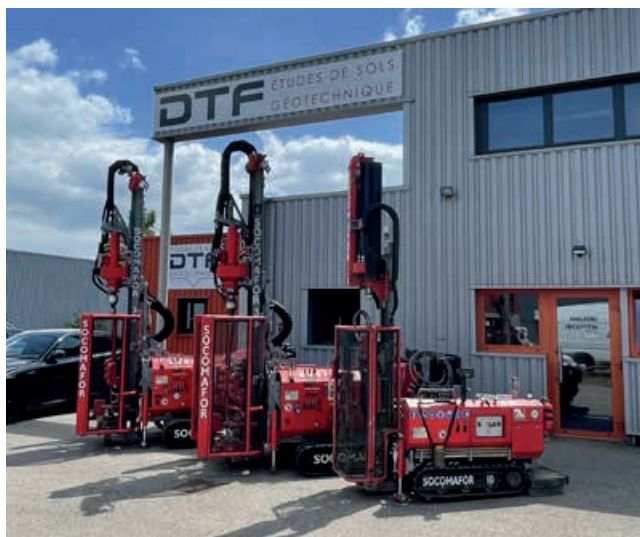
L'entreprise a investi dans 2 machines Socomafor 35 et 1 machine Socomafor 10 équipée d'un pénétromètre dynamique lourd type B avec enregistreur Apadyn.
