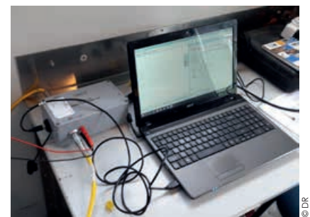
Boîtier de dérivation pour la séparation des informations sismiques (et des informations liées au cône électrique : q_c , f_s , IncX , IncY , u_2 ).
