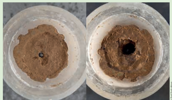
Éprouvette de sol sableux non traité avant et après l'essai d'érosion HET
