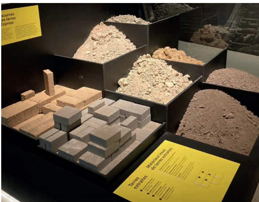
Échantillons des terres du Grand Paris Express et exemples d'écomatériaux.
